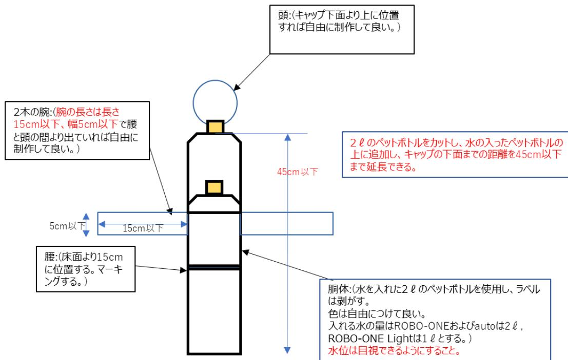
図-1 ダミーロボット(auto以外)
